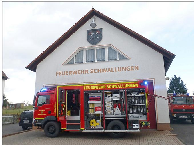
Das Fahrzeug wurde auf einem MAN Fahrgestell aufgebaut und besitzt ein automatisiertes Schaltgetriebe. Der Feuerwehrtechnische Aufbau und die Beladung wurden von der Firma LENTNER aus Hohenlinden bei München realisiert.
